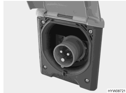
Bild 98 230-V-Anschluss am Fahrzeug (CEE-Steckdose)
