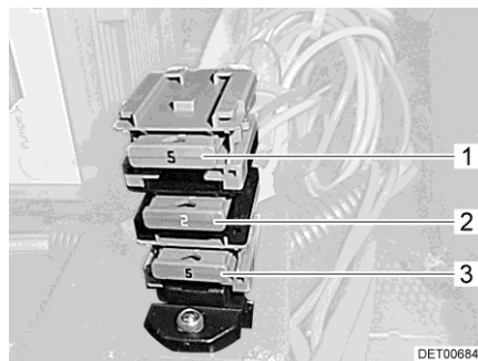
Bild 104 Sicherungen neben dem Elektroblock
