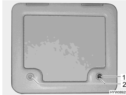
Bild 149 Klappe für den Fäkalientank
